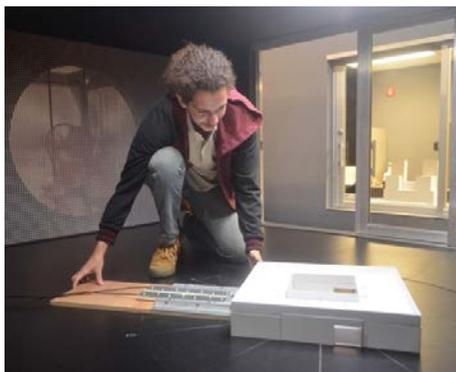
**Figura 1.** Preparación de maqueta para estudio de ventilación natural en el Túnel de Viento del LAAB
