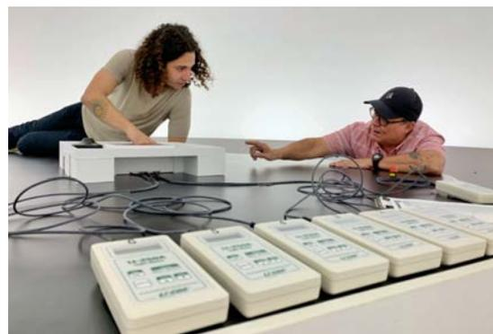
**Figura 2.** Preparación de maquetas e instrumentación para el estudio de iluminación natural en la Tropiesfera (cielo artificial) del LAAB
